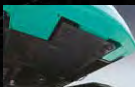
Blindage sous tourelle Les trappes d'accès sous tourelle sont en acier renforcé de 6mm.
