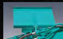
Défecteur de chutes d'objets Le déflecteur situé en bout de flèche, dévie les chutes de débris pour protéger la machine des impacts.
