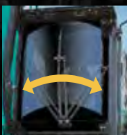
Essuie-glace à parallélogramme pour un balayage intégral
