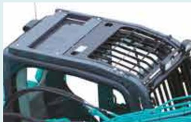
La protection FOPS est montée de série. Elle protège efficacement la cabine et le chauffeur de toute chute de matériaux ou débris, sans altérer la vision vers le haut.
