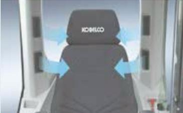
De nouvelles bouches de ventilation et un climatiseur automatique plus performant ont été installés afin d'améliorer la diffusion de l'air conditionnée et harmoniser plus efficacement la température ambiante de la cabine.
