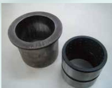
\* 2 éléments : une bague protégeant le balancier du frottement des oreilles de godet ou de l'attache rapide, et une bague autolubrifiée en contact avec l'axe. En cas d'usure, chaque bague est remplaçable individuellement pour réduire les coûts d'entretien.
