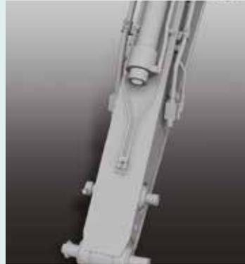
Le circuit hydraulique de pilotage de l'attache rapide est monté d'usine en standard.
