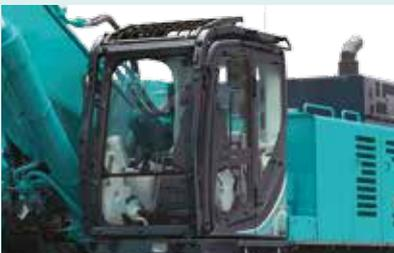
La cabine dispose d'ergots de fixation de série pour installer des protections antivandalismes (contactez votre concessionnaire KOBELCO pour poser des protections antivandalismes ou de pare-brise).
